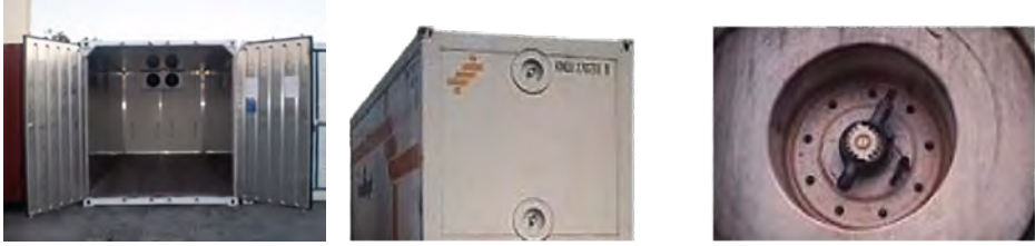
Şekil 2.11: Soğutmalı konteyner tipleri ve porthole tipi konteynerin arkasındaki sızdırmaz açıklıklar
