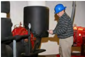
Şekil 5.1: Soğutma sistemleri için ses ölçümü
