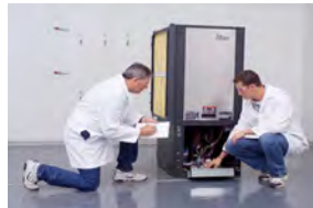
Şekil 5.1: Soğutma sistemleri için ses ölçümü
