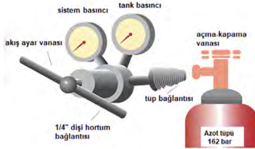
Şekil 3.8: Sistem temizleme işlemi için gerekli ekipmanlar
