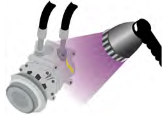
Şekil 3.10: Ultraviyole lamba kullanımı ile sızdırmazlık kontrolü
