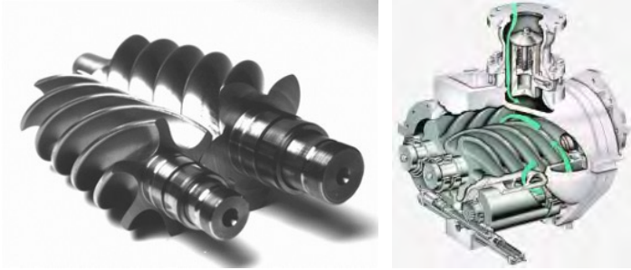
Şekil 1.4: Vidalı kompresör yapısı
