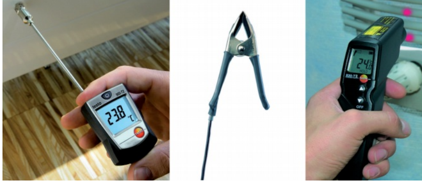
Şekil 1.16. Temaslı ve temassız (infrared) sıcaklık ölçüm cihazları
