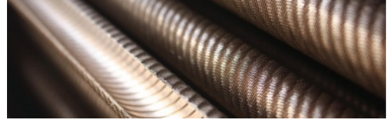
Şekil 3.17. Deniz suyu soğutmalı kondenser ve yivli boruları (Kaynak: Refkar)
