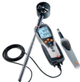
Şekil 1.18. Pervaneli hız ölçer (anemometre)
