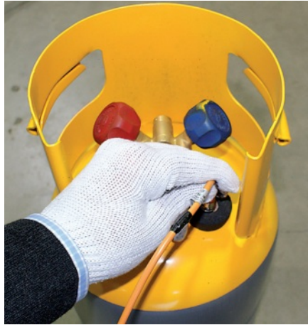
Şekil 5.138 - Geri kazanım silindiri üzerindeki ADK bağlantısının yapılması
