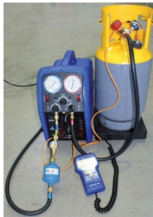
Şekil 5.139 - Geri kazanım silindiri ve geri kazanım ünitesi arasındaki ADK bağlantısının yapılmış hali.
