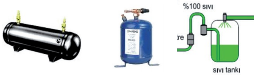
Şekil 3.38. Yatay ve dikey tip sıvı tankları
