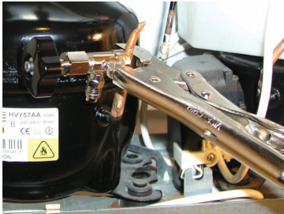
Şekil 5.151 - Delici pense servis valfinin montajı
