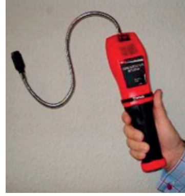
Şekil 3 – Elektronik kaçak dedektörleri tutuşucu soğutkanlar için uygundur
